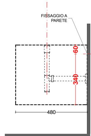
SCHEMA DI FISSAGGIO
