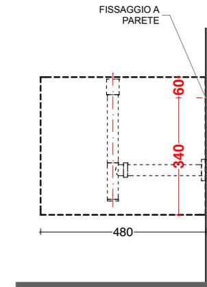
SCHEMA DI FISSAGGIO
