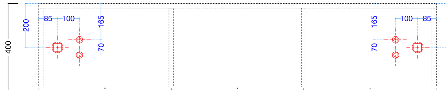
MODULO30_VERSIONE ISOLA PREDISPOSIZIONE SCARICHI E ADDUZIONE ACQUA
